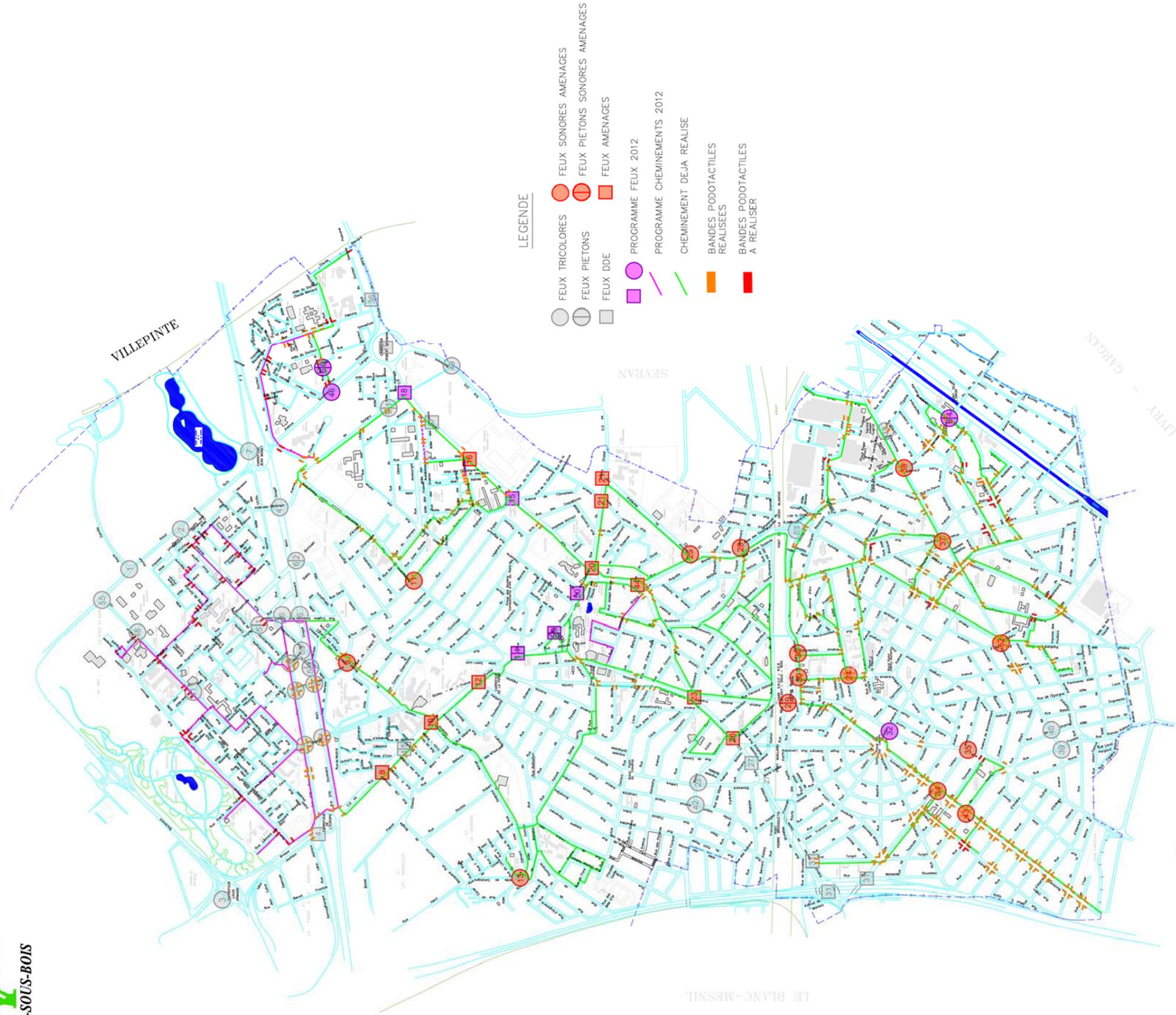
2011/5- Plan du cheminement accessible avec l'implantation des feux sonores et des bandes podotactiles
